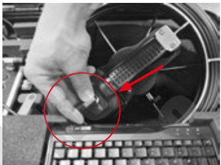
5. Подключите зарядное устройство к разъему питания / заряда аккумуляторной батареи и вставьте вилку в розетку (индикатор зарядного устройства загорится зеленым светом).
